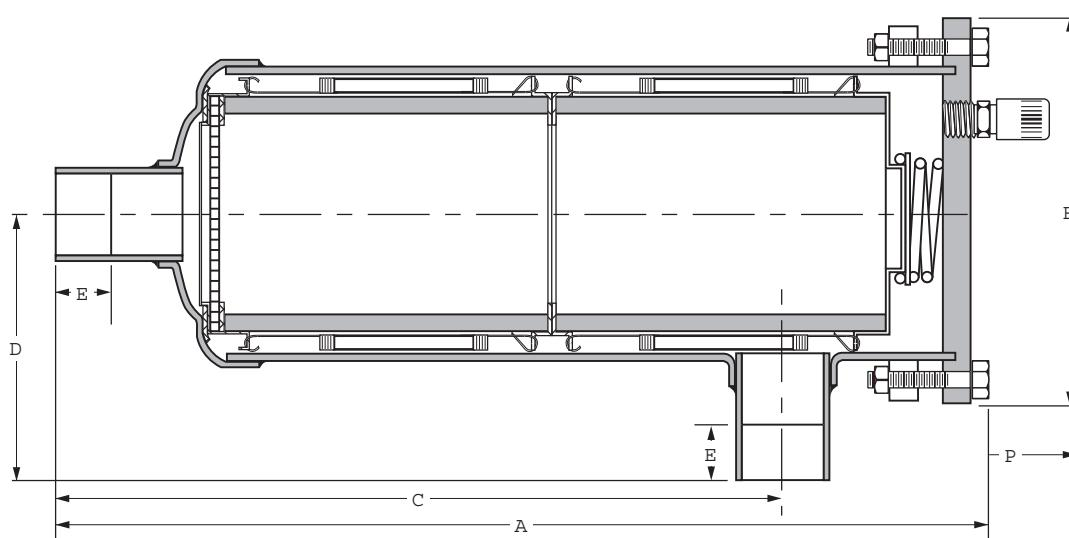
**Elementos Filtrantes** — Todos los Filtros de Succión de Elementos Reemplazables de Sporlan utilizan el Elemento de Fielto con Pliegues Tipo RPE-48-BD. El RPE-48-BD es un reemplazo directo del Elemento de Felpa RFE-48-BD. El elemento de fielto con pliegues ofrece 6 veces más área de filtración que el elemento anterior de felpa. Esto resulta en una mayor capacidad de atrapar contaminantes sólidos con una caída de presión baja.
