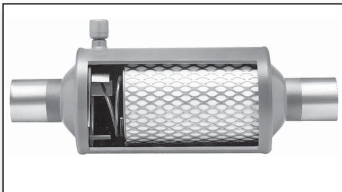
Sporlan ofrece un exclusivo concepto en el diseño de los Filtros de Succión – un filtro con una característica opcional de alivio de presión. Cuando el flujo es en una dirección, el dispositivo de alivio de presión se activa. Si la caída de presión a través del elemento llegara a ser excesiva, el dispositivo de alivio de presión abrirá ligeramente con el fin de mantener un flujo suficiente de gas asegurando el enfriamiento apropiado del motor hermético.
