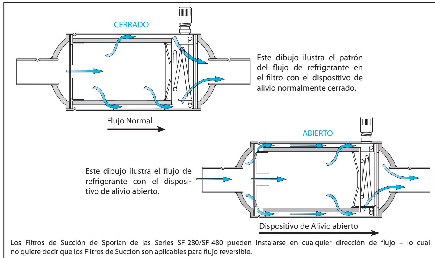
**OPERACION — SIN LA CARACTERISTICA DE ALIVIO DE PRESION —** Dirección de Flujo en Sentido Contrario – Los modelos SF-280/SF-480 pueden instalarse con el flujo en cualquier dirección, dependiendo de la preferencia del usuario. Sin embargo, en aplicaciones de Bombas de Calor
