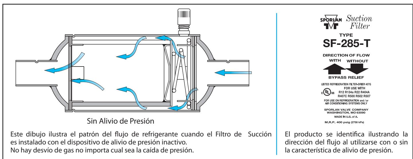
**APLICACION —** El Filtro de Succión debe utilizarse en la línea de succión – no como un filtro de línea de líquido. El Filtro- Secador Catch-All está diseñado para usarse en la línea de líquido para proteger al sistema contra la humedad excesiva, contaminantes sólidos y ácidos. La aplicación de mayor importancia del Filtro de Succión es en sistemas remotos con líneas largas. El filtro, al arrancar el sistema, atrapará contaminantes sólidos acumulados en el evapora-
